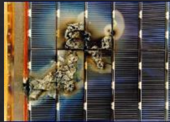
Panneau solaire endommagé
