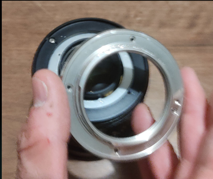
Demontage de la monture (4 vis)
