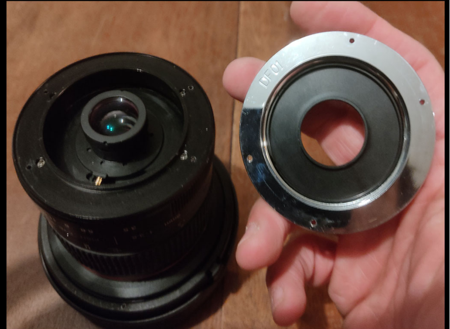
Monture retirée Anneau interne diamètre 49mm Adaptation facile sur le renvoi cou
