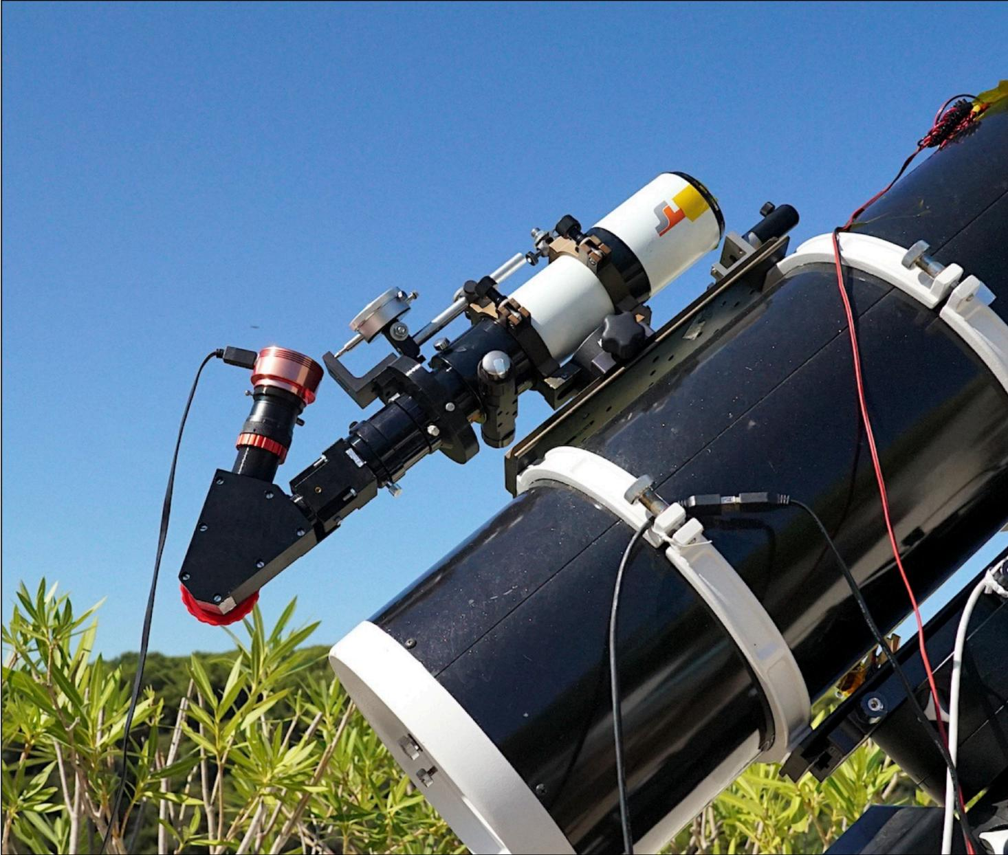
Sur modèle TS, D = 65 mm - F = 450 mm - Noter l'usage d'un micromètre de mécanicien pour faciliter la focalisation.
