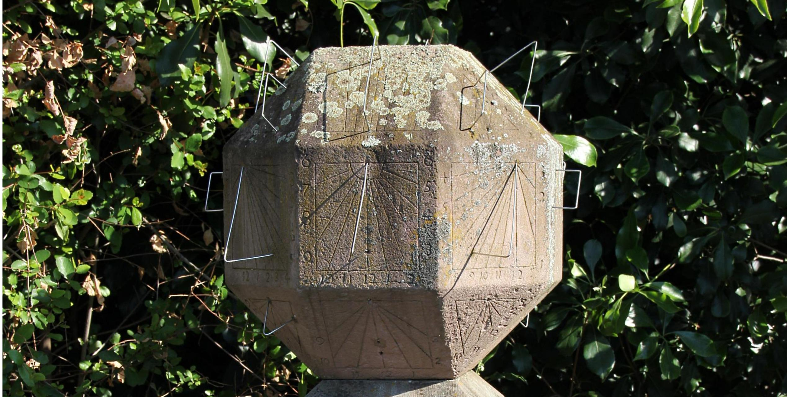
Un cadran peut d'ailleurs être orienté de façon quelconque, voir être tracé sur une surface non-plane. La seule contrainte est qu'il soit éclairé au moins à un moment dans la journée, ou dans l'année.
